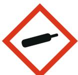
Gasflaschen unter Druck können beim Erhitzen explodieren.
